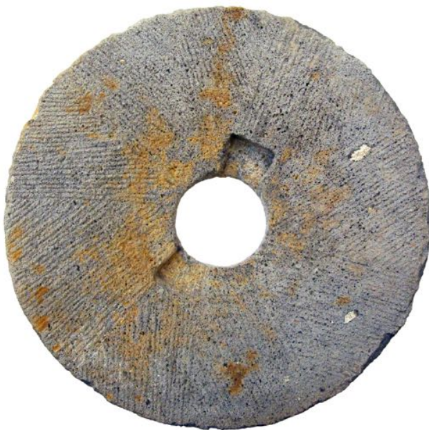
Afb. 1. Grote maalsteen van onderen gezien toont het maalvlak. Het linksdraaiend recht pandscherpsel (groevenpatroon) is zichtbaar. Twee inkepingen naast het kropgat geven de positie van de rijl aan.
