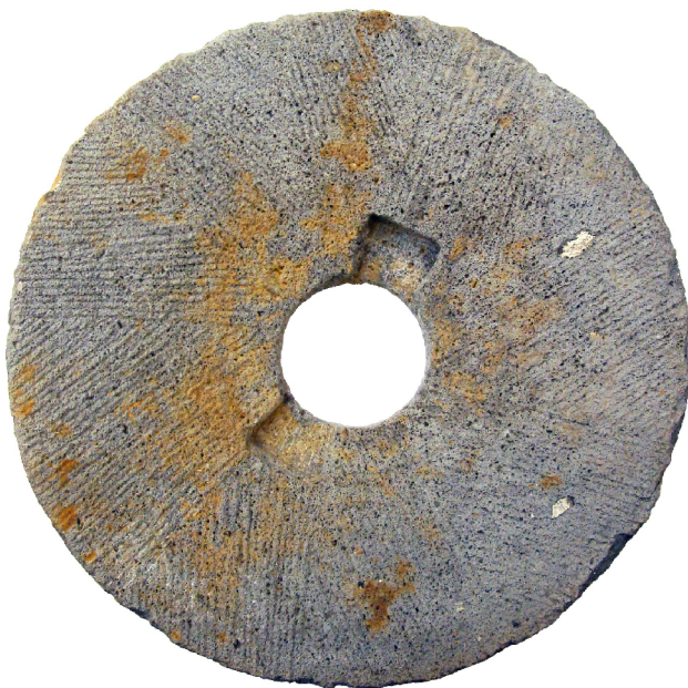
Afb. 1. Grote maalsteen van onderen gezien toont het maalvlak. Het linksdraaiend recht panscherpsel (groevenpatroon) is zichtbaar. Twee inkepingen naast het kropgat geven de positie van de rij aan.
