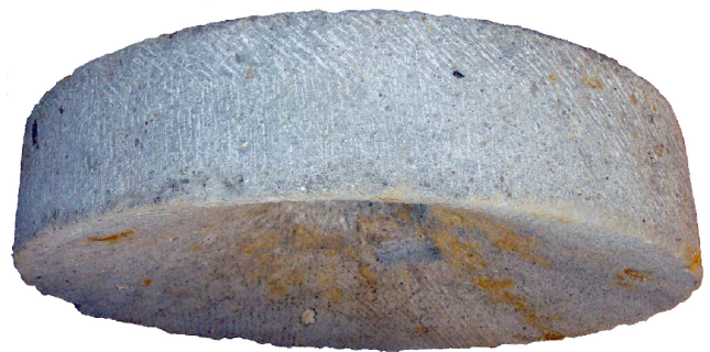
Afb. 2. Dezelfde maalsteen, zij- en onderaanzicht van de werkende positie van deze lopersteen. Goed is de concave vorm van het maalvlak te zien, die moet aansluiten op het convexe maalvlak van de eronder te plaatsen (ontbrekende) liggersteen.
